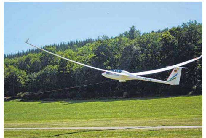
Eine Motorwinde beschleunigt das Flugzeug derart, dass es abhebt. Die Luft biegt die Flügel nach oben.
