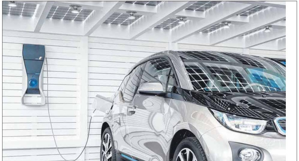
Doppelter Nutzen: Das Solardach des Carports schützt nicht nur das Auto, sondern gewinnt bei Tageslicht Energie. Damit kann wiederum der Akku des E-Fahrzeugs aufgeladen werden.
